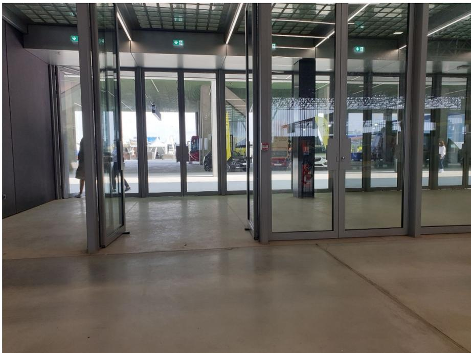
Portes vitrées sans dispositifs permettant aux aveugles et malvoyants d'être alerté et de ne pas se cogner dans les vitres
